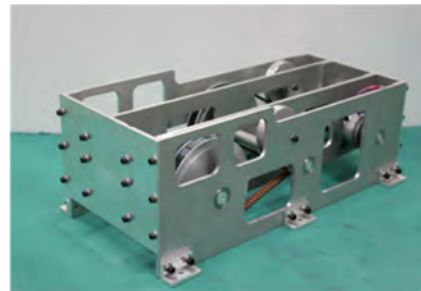
Fig.3 MG 合金使用 駆動部ユニット
