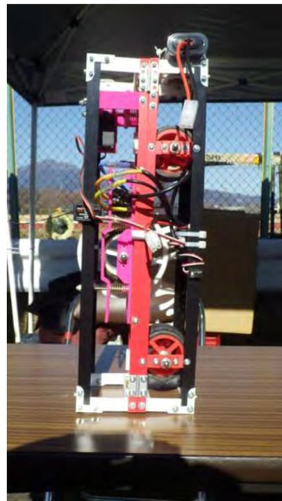
イヤ』を一体化させた部品を3Dプリンターにて製作した(試作2号機)。また、総重量は試作機2号機の段階で、2.5kgと重いと感じた。そのため、目標を1kgに設定し
